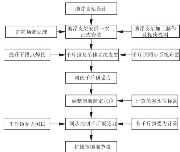
图1 助浮支架施工总体流程图
