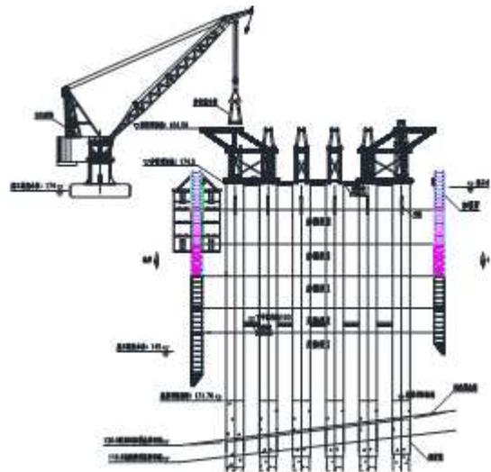
图4 助浮支架安装步骤示意图
