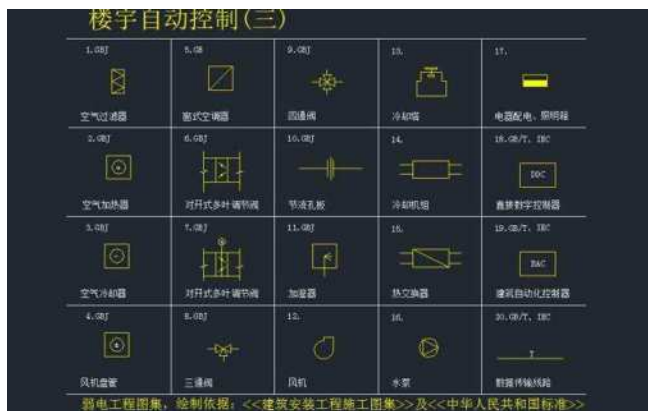
图3 弱电系统标准 cad 图例
