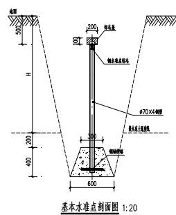
②阶段二：地下部分与阶段一相同。地下部分完成后坑内不再填土。为方便日常使用，在施工过程中地下部分完成后采用长度为 1 米外径 600mm 混凝土管对水准点进行保护，上覆圆形井盖，水准点易于发现和使用。但雨天和地势低洼处，雨水会通过井盖上的空隙进入混凝土管内，造成管内积水，长时间积水会影响水准点的正常使用。为解决这一问题，用直径 20mm 的冲击钻在混凝土管斜向凿孔 2 眼，以便管内积水及时排出。在对应的监测站井口保护设施上喷涂用以指示水准点的距离和方位。
