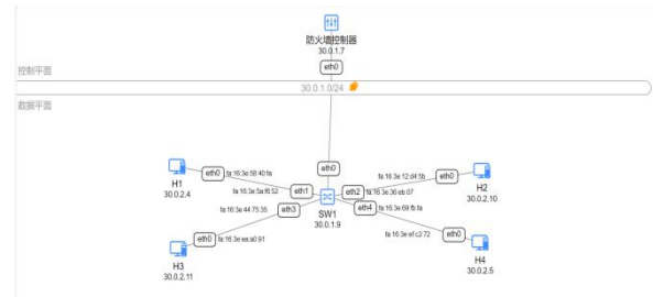
图 2 SDN 安全防御机制实验拓扑
