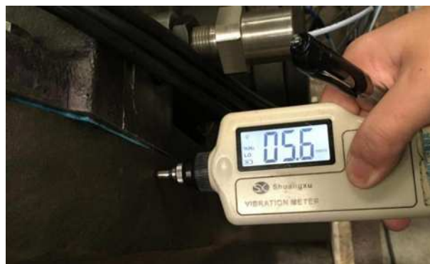
图1 试车时检测轴承振动超标
