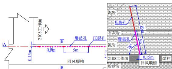
图 1 聚能爆破切顶+水力致裂示意图
