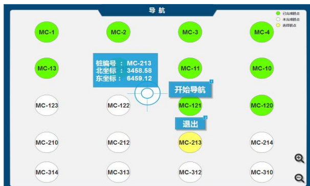
施工过程中桩点引导功能
