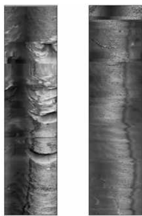
图4 顶板预裂切缝孔爆破窥视效果图
