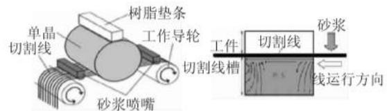
图2 多线切割原理图
