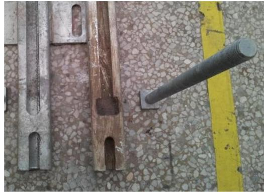
图7 方头螺栓及其配备滑槽
