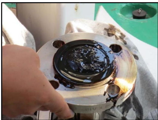
图7 被油泥盖住的检测膜片
