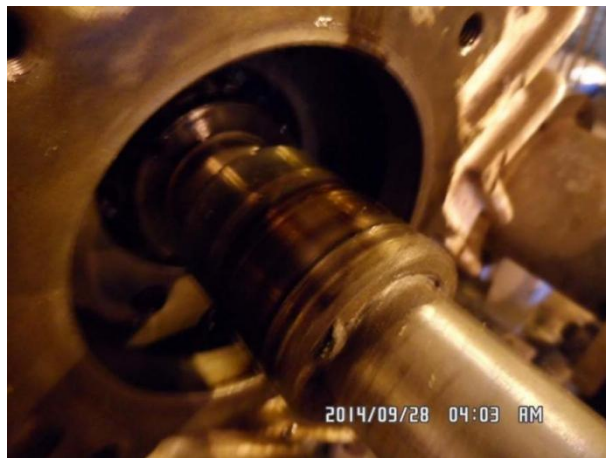
图9 电机与泵体间的轴套及油封已经磨损
