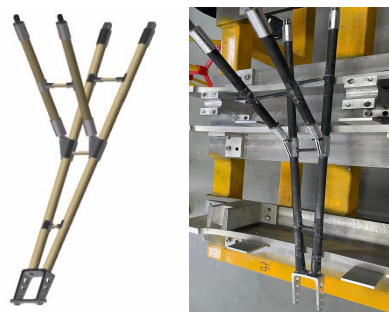
图 1 桁架式主起落架设计模型及实物
