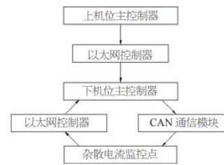
图2 杂散电流数据采集系统
