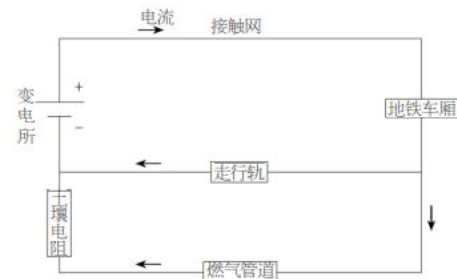
图1 地铁系统等效电路示意图
