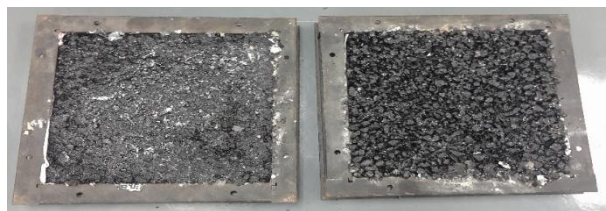
图 3-2 灌浆后的试块和成型后的试块
