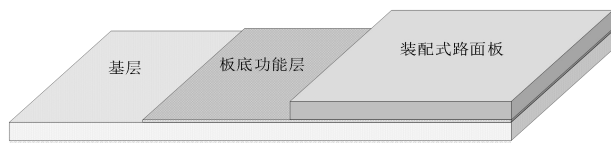
图1 装配式路面结构组合示意图
