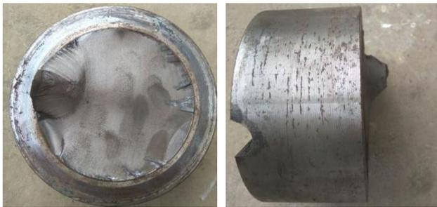
图3 1B磨拉杆2017年8月4日断裂位置图
