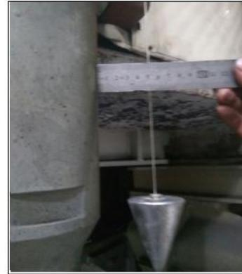
图5 拉杆垂直度测量
