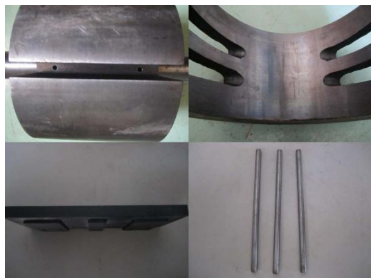
图3 新的转子、定子、滑片、顶杆
