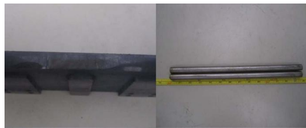
图6 拆检后的滑片、顶杆
