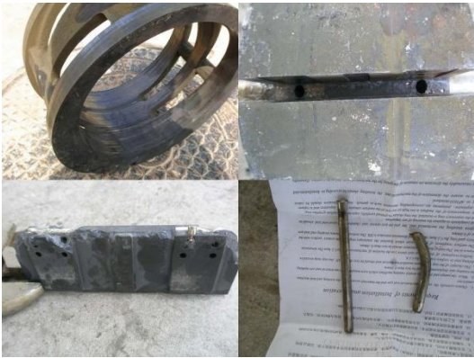
图 2 损坏的定子、转子、滑片、顶杆
