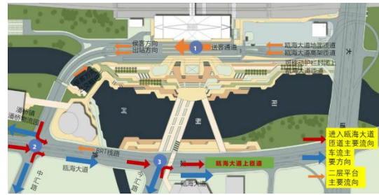
图 2.2 优化后机动车交通流线组织图
