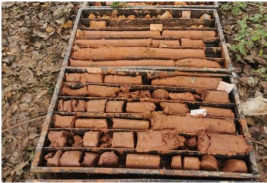
图 2 项目现场典型软土钻芯土样
