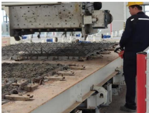
图 2.1 预制墙在振捣台平放浇筑
