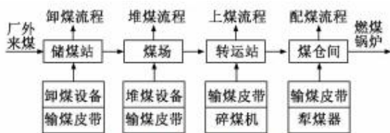
图 1 发电厂输煤工艺流程
