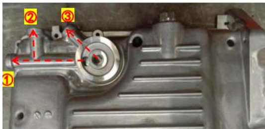
图1 机油盘典型油路结构
