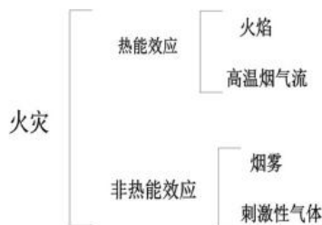
图1 建筑火灾的危害
