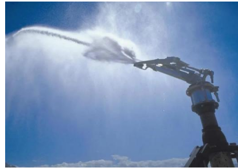
图1 高压喷雾降尘处理措施
