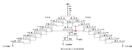
图 1 流程图中红色圆圈为精 3 尾矿泵设置位置
