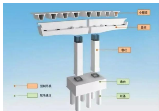
图1 预制拼装桥墩连接构造类型
