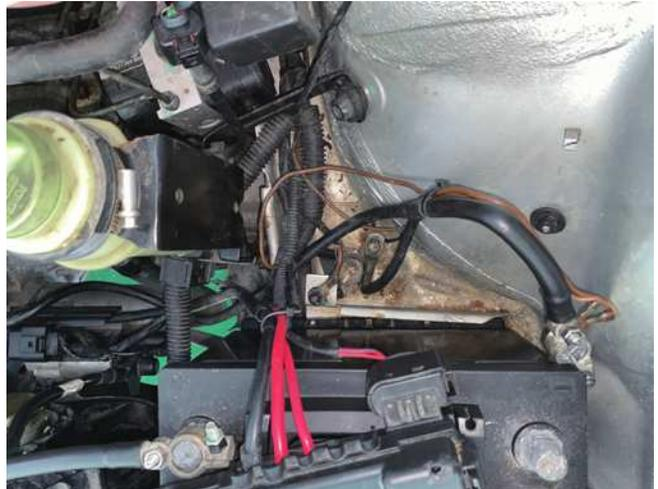
图 4 搭铁点连接松动
