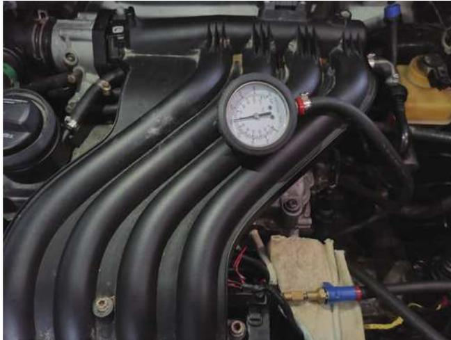
图 3 燃油压力检测
