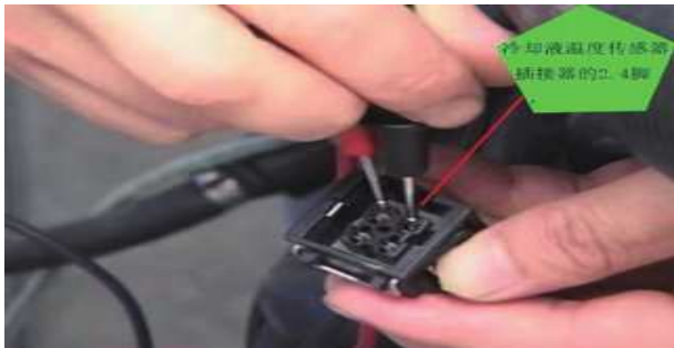
图二 万用表检测水温传感器
