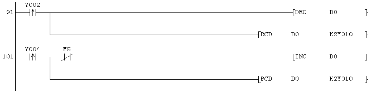
图8 计数器数值增减, LED 数码管显示程序
