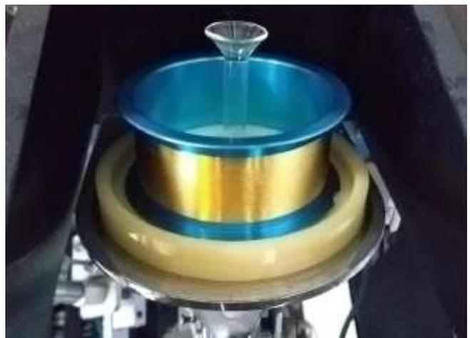
图 2 自动键合机上装载的 25um Au 线
