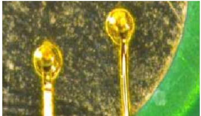
图 1 Cu 基板上的 Au 丝球焊点
