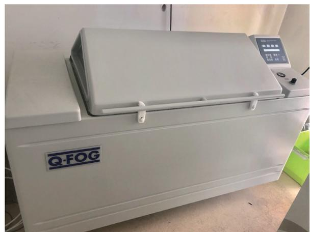
图 3 Q-fog CCT 型盐雾试验箱 (CCT600)
