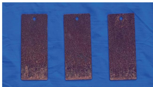
图8 试样12周户外曝晒测试(无顶棚)后的状态
