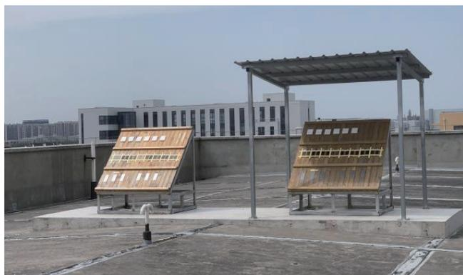
图5 试样在户外曝晒测试台架上的放置状态
