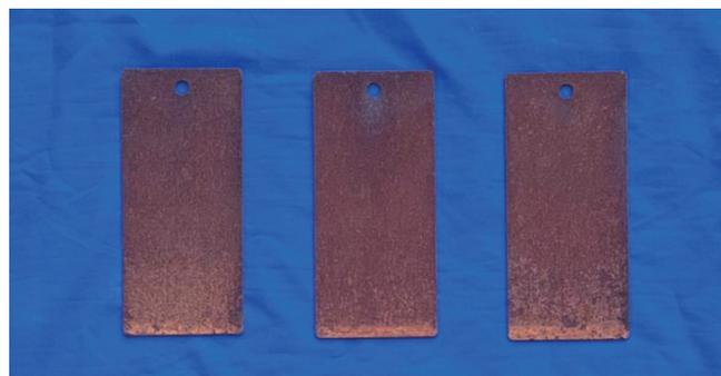
图7 试样12周户外曝晒测试(有顶棚)后的状态
