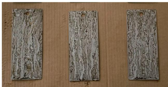
图6 试样48h中性盐雾腐蚀试验后的状态
