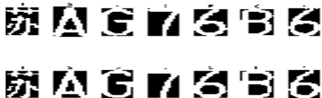
图 5 黑色车身字符分割算法结果图
