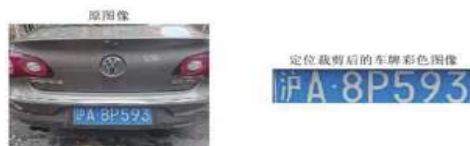
图 6 褐色车牌定位算法结果图
