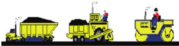
图2 沥青路面施工最重要的压实环节
