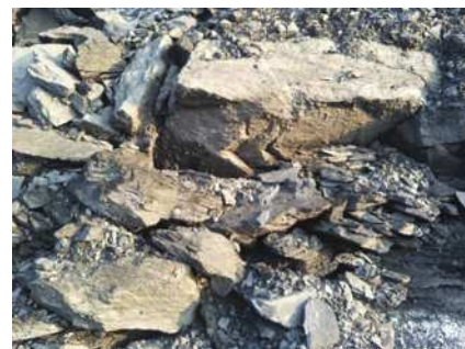
图1 经风化后的炭质泥岩较为破碎
