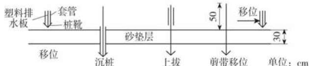
图1 塑料排水板插板工作流程
