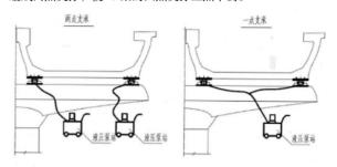
将作为临时支点的千斤顶调整到设计高度,然后将梁放入千斤顶,然后用特殊的支撑灰浆在支架和基座底部之间进行填充,大约2个小时,在支撑砂强度达到设计容许强度并不小于20Mpa的情况下,拆卸千斤顶,使U形梁的重量转移到正规支架上,这样,架桥机械就可以通过钻孔前进。
