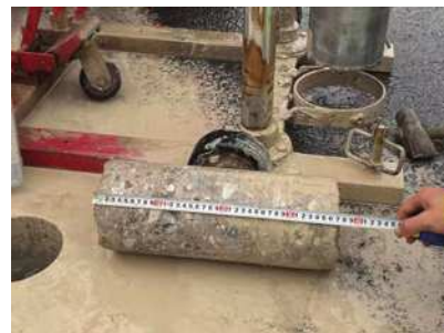
图2 水泥稳定碎石基层冷再生芯样
