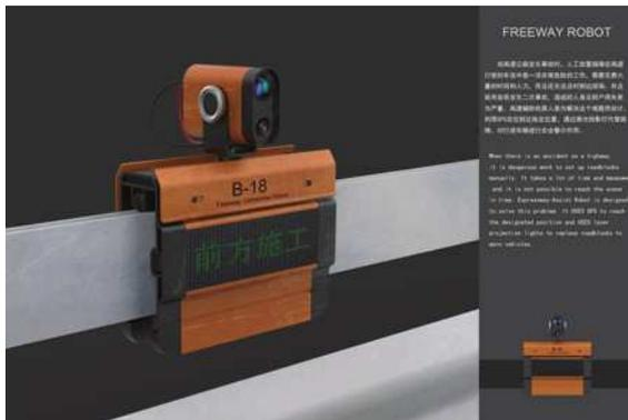
一旦发生拥堵或交通事故，监控员直接在 PC 端或手机端发出操作指令，机器人结合卫星定位及高速公路里程桩号准确到达指定位置进行预警。在 4 公里辐射范围内，机器人最迟 6 分钟即可到场，在预警车不能及时到达的情况下，机器人预警的提前介入可保障周边通行车辆的安全。
