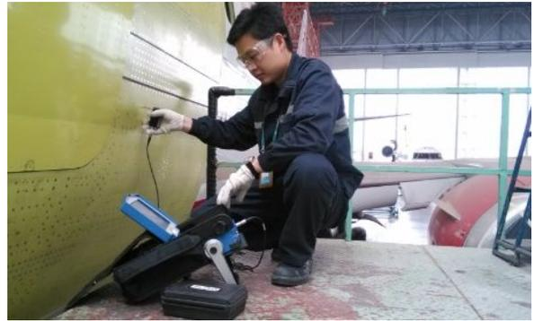
图3 无损检测法
