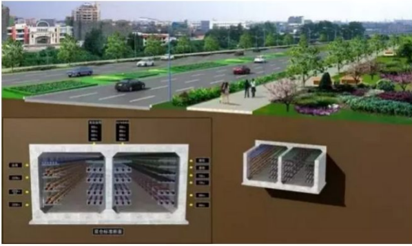
图2 城市综合管廊系统图示
