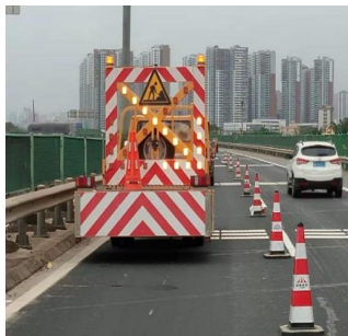
2 施工作业防撞车应用
