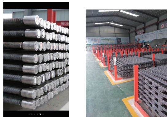
图 2 钢筋数控下料
