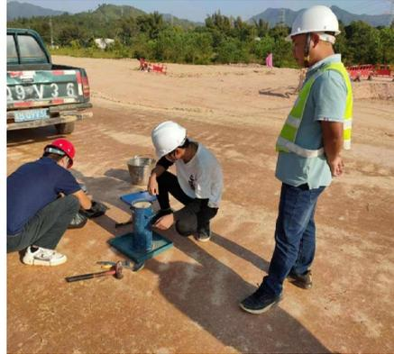
图2 路基压实度检测图
