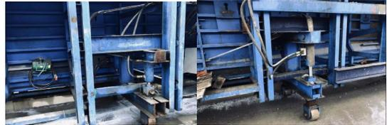
图 2 模板高度、横坡度调节油缸系统
