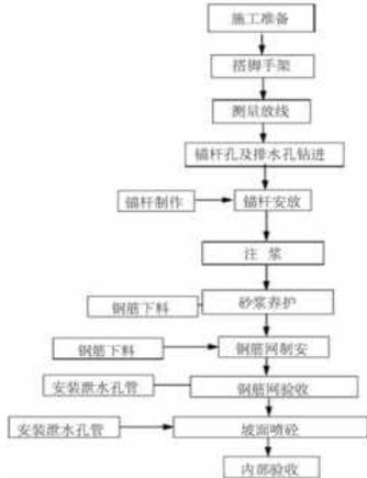
图 1:挂网喷锚施工工艺流程
