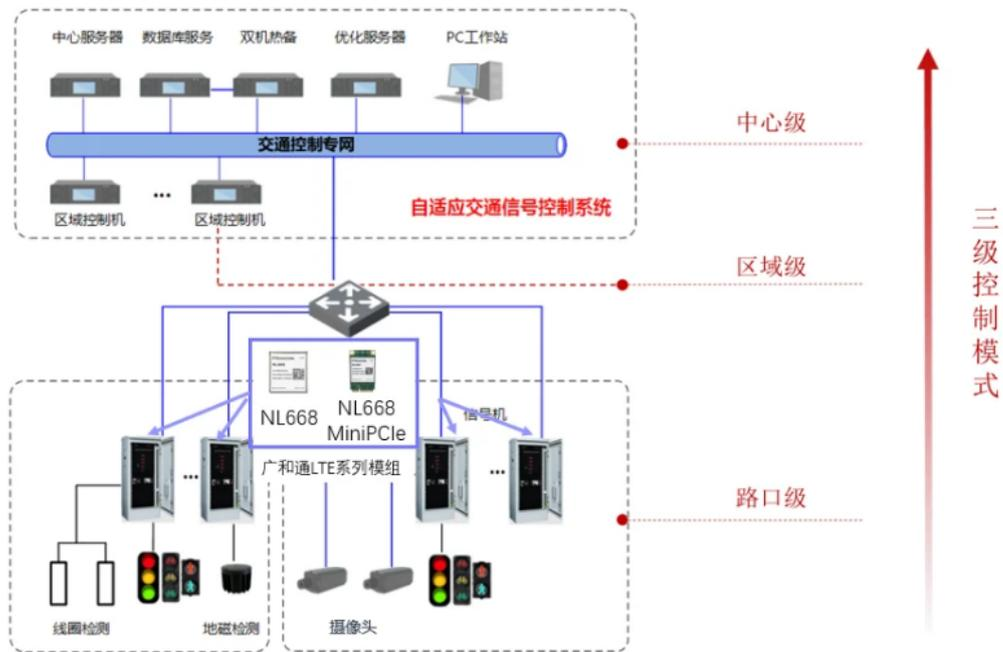
图 2 交通信号控制系统分布图
