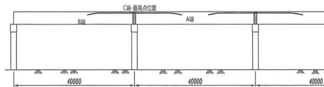
图 4 简支转连续预应力孔道示意图
