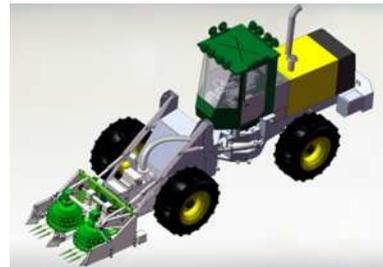
图 1 柠条收获机整机虚拟样机图
