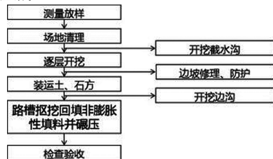
图1 挖方路基工程施工流程
