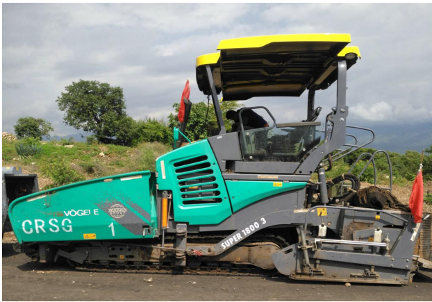
图1 现场准备施工中的维特根(福格勒 S1800-3 型沥青摊铺机)负担,易造成设备损坏和材料超耗,增加不必要的成本。在我方摊铺特恰 4km 路段时因摊铺厚度超标曾损坏叶片 60 片,连接螺栓(10.9 级)100 根;而正常设备参数操作下 2019 年度仅更换叶片 2 片,连接螺栓(10.9 级)6 根,其余均为保养件;前后对比,在设备设计参数下合理使用可节约较多成本。
